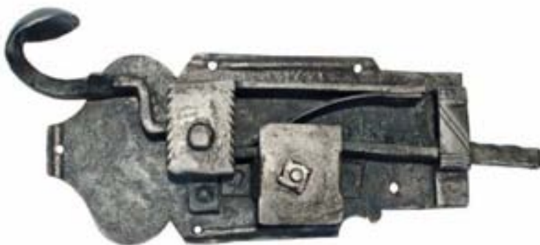
0533 Einfaches Drückerschloss mit einer hebenden Falle und Blattfeder. Der Außendrücker ist im Angriff mit einem Bart versehen und wird nach dem Schließen abgezogen. Leichte Linienverzierungen. Größe: 28 x 11 cm Schlüssel: Drücker als Schlüssel original Zeit: um 1790 Herkunft: Österreich, Vorarlberg
