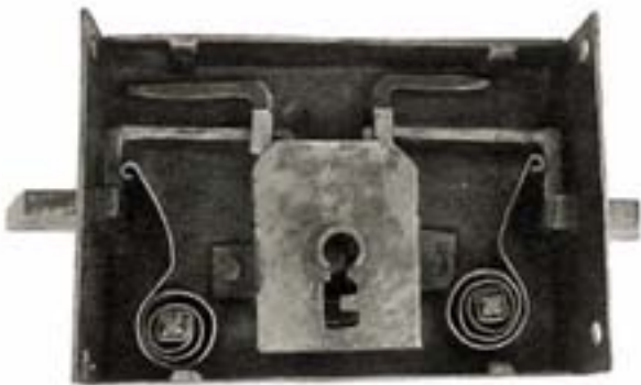
0807 Schrankschloss, wurde auf dem Mittelfries für zwei Türen montiert. Jede Seite hat eine schießende Falle. Mechanik im Kasten verborgen. Größe: 19 x 10 cm Schlüssel: Volldornschlüssel aus der Zeit, Bart angepasst Zeit: um 1810 Herkunft: Nordostschweiz
