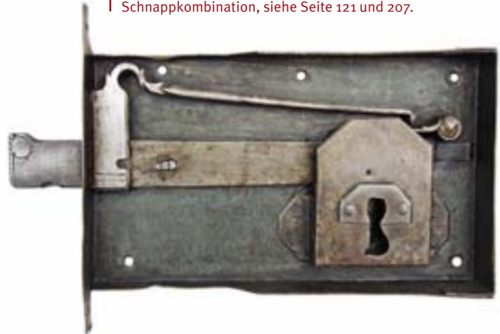
0520 Türschloss als Kombination von Schnapp- und Tourschloss. Innen ist am Fallenkopf ein Heber angebracht. Die Falle wird durch eine Schlüsselbewegung nach rechts oder durch den Heber geöffnet. Die vordere Fallenführung wurde als Schenkelfeder gearbeitet und wirkt über die Kurzhebelumlenkung auf die Zuhaltung. Größe: 20 x 30 cm Schlüssel: Volldornschlüssel aus der Zeit, Bart angepasst Zeit: um 1780 Herkunft: Nordwestitalien
