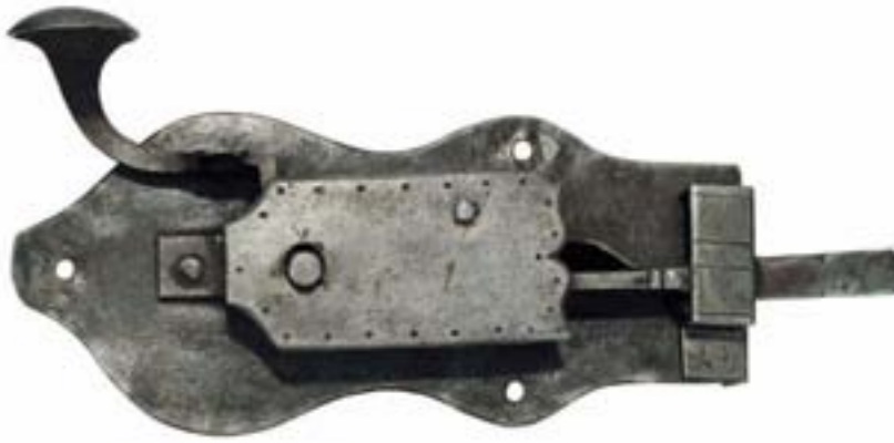
0534 Einfaches Drückerschloss mit einer hebenden Falle. Der Außendrücker hat ein Innengewinde und ist abnehmbar. Auf dem Innendrücker sitzt das Außengewinde. Leichte Linien- und Punktverzierung. Größe: 28 x 10 cm Schlüssel: Drücker als „Schlüssel“, original Zeit: um 1800 Herkunft: Süddeutschland, Allgäu
