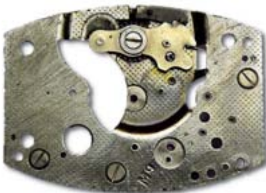
Produktionscode eines Junghans J96 unter dem Zifferblatt M9 (Dezember 1939)
