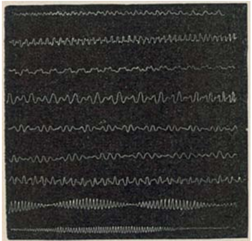
Abb. 4: verschiedene Schallwellen auf rußgeschwärztem Papier
